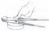
Introducir el eje de la aguja minutera en el cañón de la maquinaria y presionar hasta el fondo.
