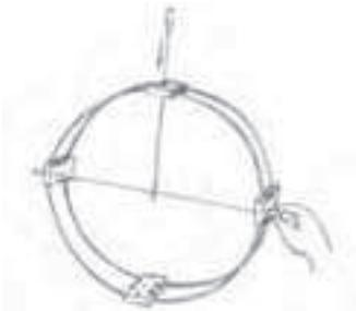
Introducir el tensor con la caja de maquinaria (d) en los agujeros posteriores de las piezas de madera (a) y fijarlos con el terminal tensor roscado (e).
