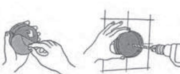
Despegar el protector adhesivo para fijar la caja en el lugar elegido o utilizar el orificio central para atornillarla.
