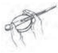
Introducir la aguja horaria presionando sobre el eje de la máquina hasta que haga tope.
