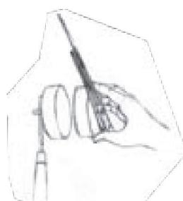
Construir el soporte-pie, uniendo con el tornillo (5) los dos cilindros metálicos (2 y 3) formando una T.
