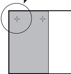
Ändern der Aufhängrichtung: Lösen der beiden Schrauben, Aufhängung um 90° drehen, Schrauben erneut festschrauben
