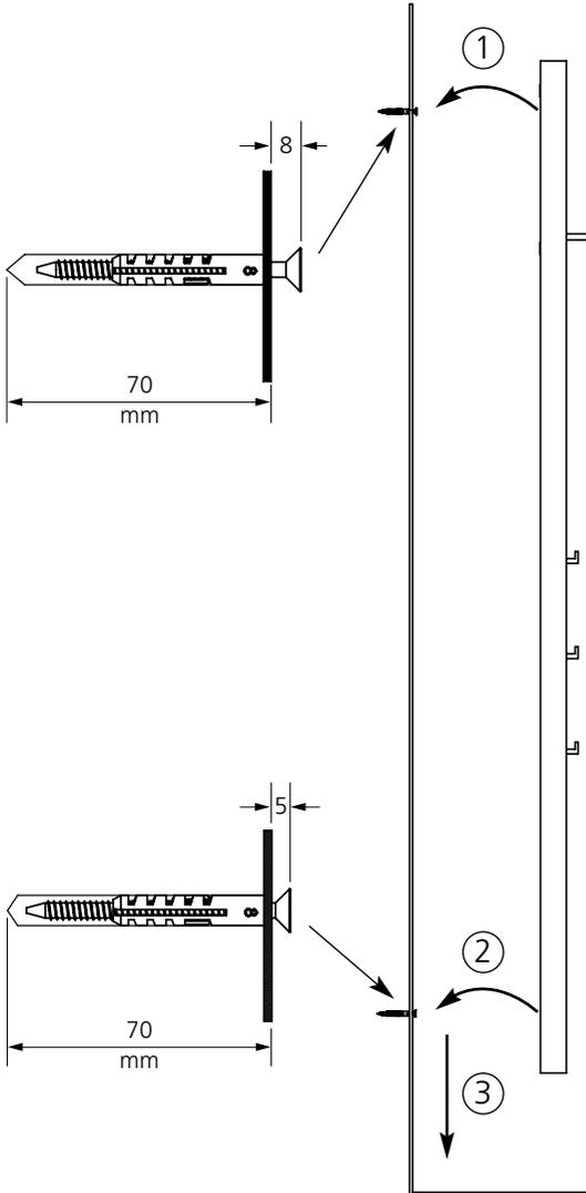
1. In der oberen Wandaufhängung einhängen / Insert into the upper wall mounting
