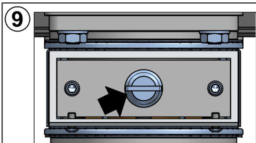
Se necessario, per rendere fluida la rotazione delle allunghe, agire sulla vite svitandola o avvitandola.
