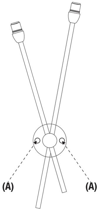
2 Passare i cavi di rete nel foro centrale del particolare (B).
